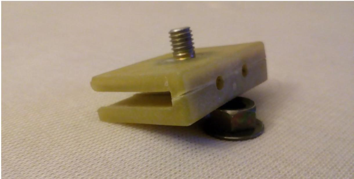
Die Scheiben, ob elektrisch oder Manuell, werden mit diesen kleinen Kunststoffhaltern an der Schiene des Fensterhebers befestigt. Zwei pro Scheibe.
