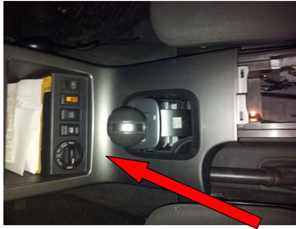
Wahlhebel auf D stellen, Konsole hier erst schräg nach hinten oben ziehen, hier schräg nach hinten oben über die Gummidichtung ziehen, dann schräg zur Seite legen.
