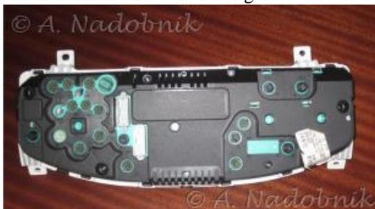
Die hintere Abdeckung kann man lösen in dem die fünf Torx-Schrauben (TX 10) entfernt werden...
