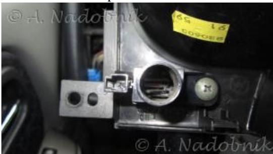
Das Kombiinstrument ist mit vier Schrauben befestigt.
