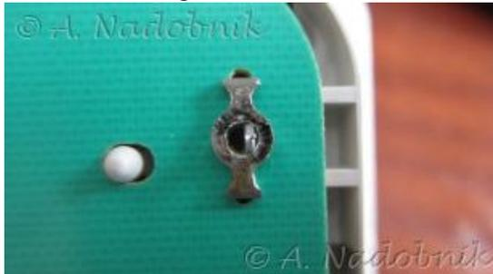
Außerdem ist der Schirm noch mit vier Ösen an der Platine eingehakt. Diese kann man leicht mit einem Schlitzschraubendreher lösen.
