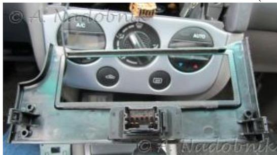
Die Blende der Lüftungsdüsen ist unten mit zwei Schrauben befestigt. Hier sieht man die rechte Schraube kurz vor dem Herausdrehen.
