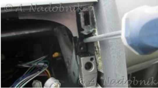
Oben ist die Blende der Lüftungsdüsen mit Plastikhaken ausgestattet. Wie die aussehen und wie man sie lösen kann, sehen Sie auf den nächsten beiden Bildern.
