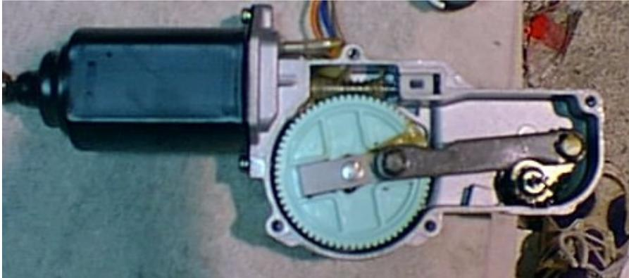
Jetzt den Sicherungsring vom T-Stück zum Verbindungsstück entfernen. Mit einem Bohrer (10mm oder etwas größer) auf der gegenüberliegenden Seite der schon Vorhandenen Versenkung, ebenfalls eine Senke bohren sodass das T-Stück um 180 Grad gedreht komplett eingesetzt werden kann.
