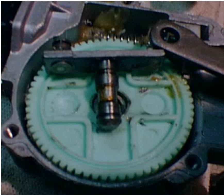
Jetzt das Verbindungsstück wieder auf das T-Stück setzen und ALLE Sicherungsringe BEVOR der Decker aufgeschraubt wird wieder einsetzen.
