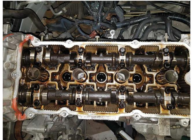
Vorm öffnen der Nockenwellenlager nochmal genau die Markierungen merken wegen der Position beim Zusammenbau.
