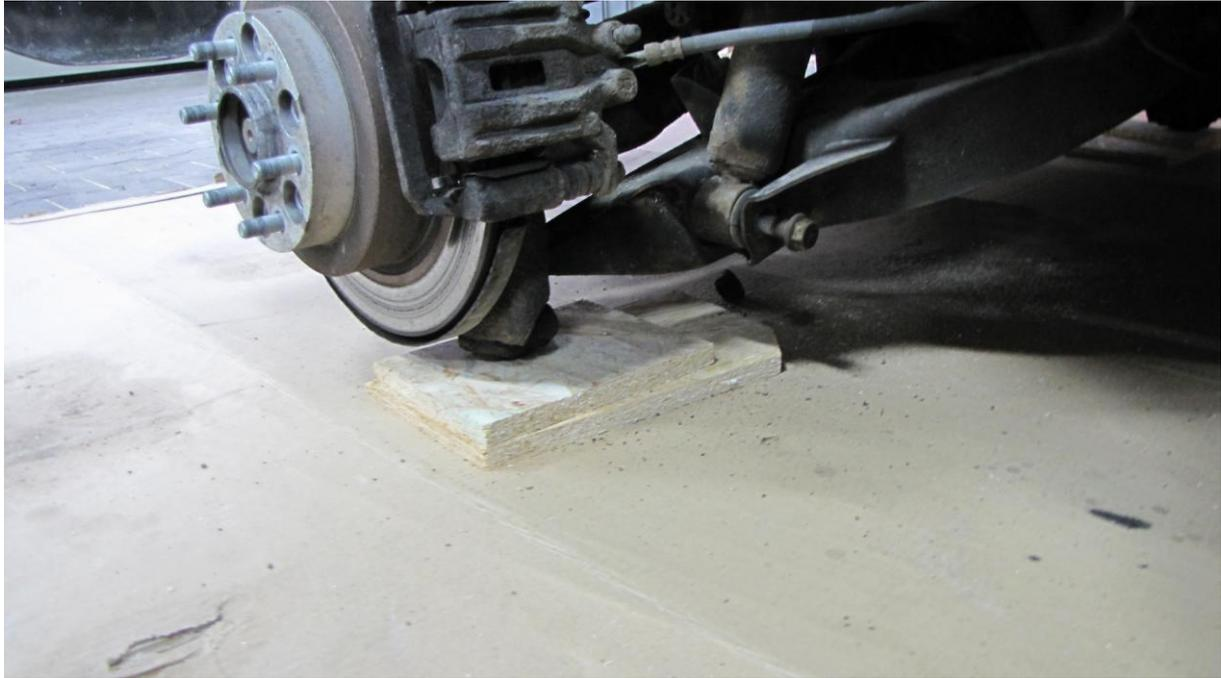
Unteren Stoßdämpferbolzen rausklopfen, dieser ist jetzt entlastet
