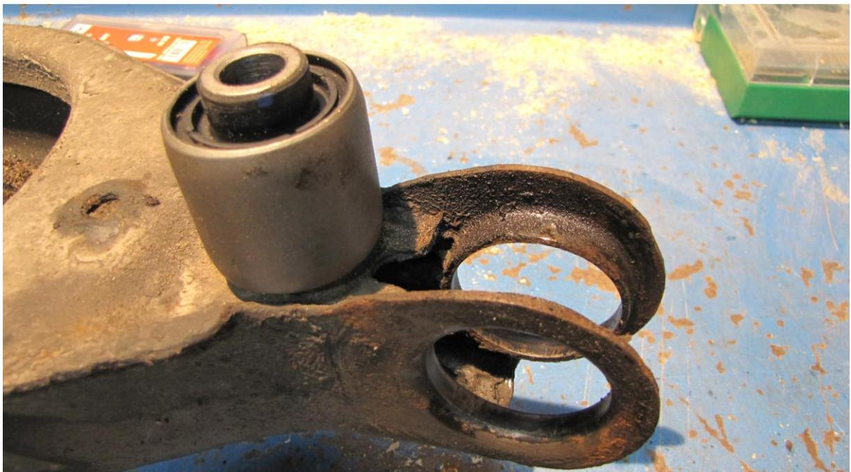
mit ein paar leichten Hammerschlägen lässt sich das nach innen biegende Auge aber ganz leicht nach Aussen von der Hülse über den Pressdorn hinweg klopfen.
