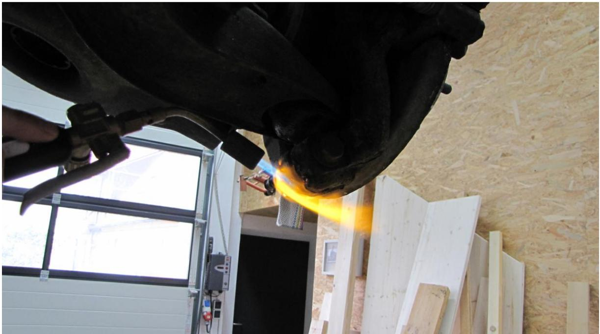
Immer im Wechsel Schlagschrauber und Hammer mit Messingdorn, bis der Bolzen raus ging. Es ist kein Gewinde in der Klemmung, es hält wirklich nur der Rost !!
