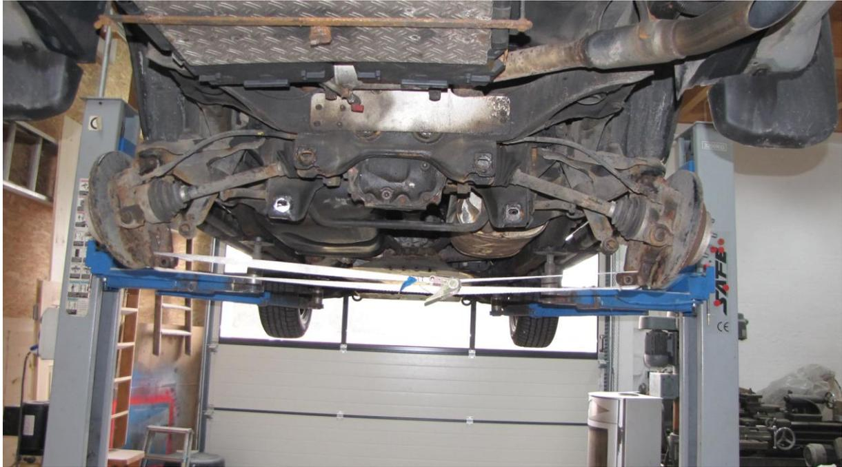
Jetzt kann der Unterlenker weiter entfernt werden, dazu muss der vordere Bolzen raus. Dieser ist kein Excenter und geht gut raus muss aber auf der linken Fahrzeugseite trotzdem abgeflext werden, weil der Tank im Weg ist.
