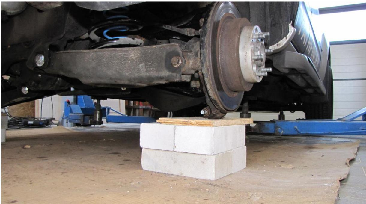
So drehen sich die Bauteile alle in die Position, in der sie sich später die meiste Zeit befinden werden und die Schrauben können alle festgezogen werden.
