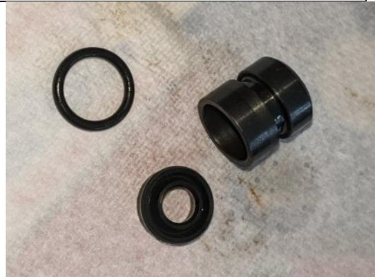
20 wechseln Dichtungen & zusammenbauen:
