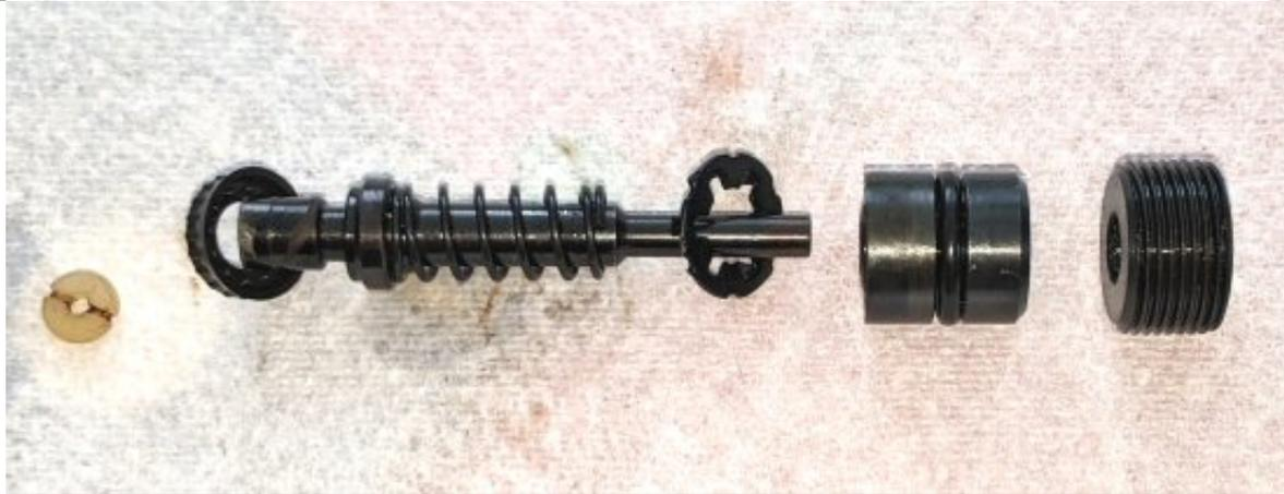
18 prüfen den Kolben und O ring:
