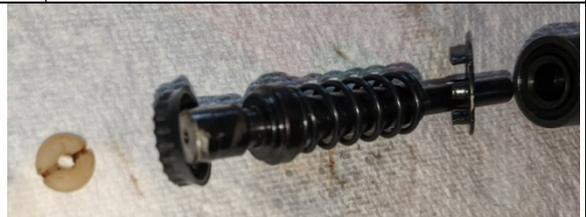
35: Einzelheiten von Nylon, Spindel, Kolben, Dichtungen 1, 2 & 3 und Stopfen:
