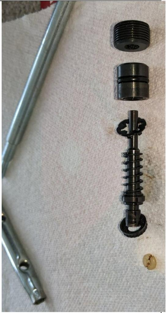
33: Einzelheiten von Spindel, Nylon Scheibe & Dichtung 3:
