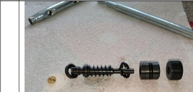
34: Einzelheiten von Nylon Scheibe, Spindel, Kolben, Dichtungen 1, 2 & 3 und Stopfen:
