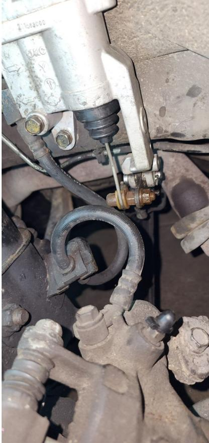
51 Bremserohr und Verknüpfung spannen:
